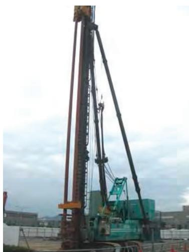
写真 4.13.2 2 軸地盤改良機
