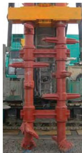
写真 4.13.3 攪拌翼の詳細
