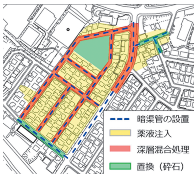
図 3 各地盤改良工の適用箇所 3)
