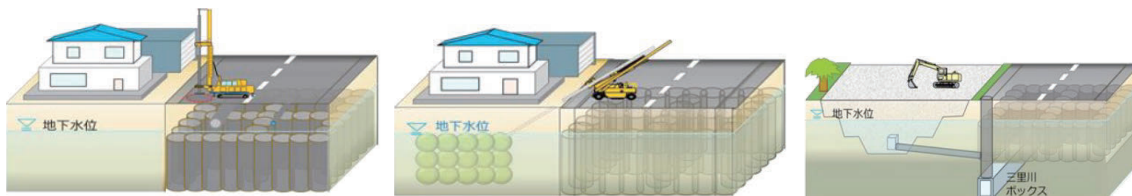
(a) 道路部・深層混合処理工法 (b) 宅地部・薬液注入工法 (c) 公園部・砕石置換工法
