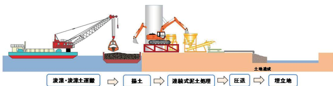
図1 埋立材として活用した施工手順
