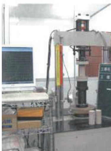
写真3 一軸圧縮試験状況
