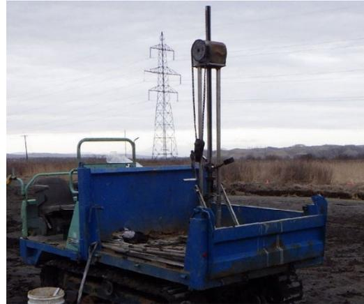
写真1 機械式コーン貫入試験機の全景
