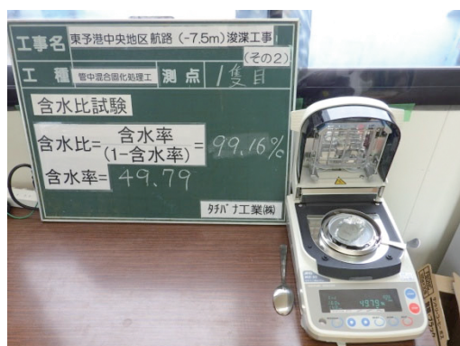
写真 2 浚渫土の含水比測定状況
