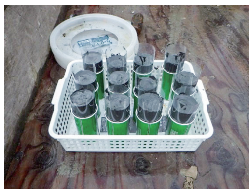
写真 5 供試体の作製状況
