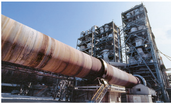
トクヤマ南陽工場の巨大なキルン(回転窯)。1,450℃の高温で焼成するため、 副原料として使う廃棄物は無害化され、二次廃棄物も出ない。
