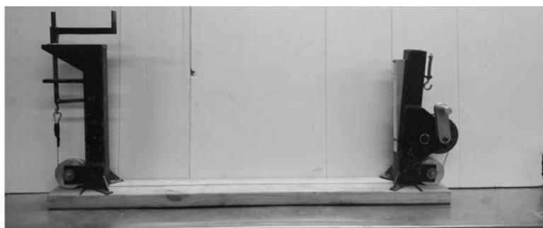
写真1 そりの測定装置の外観
