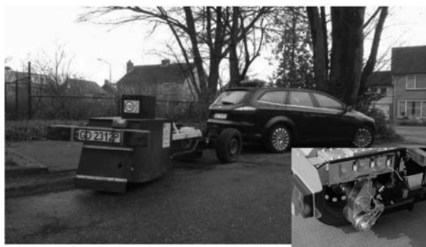
写真1 転がり抵抗測定トレーラと転がり抵抗測定装置詳細
